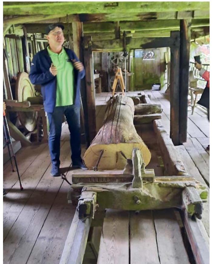
Uralt-Sägewerk mit Venezianer Sägegatter
